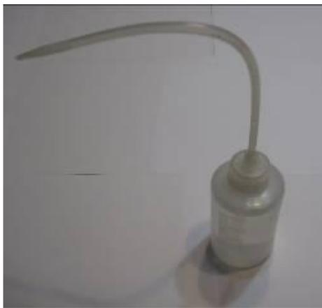
圖 5 蒸餾水（清洗測試筆用）
