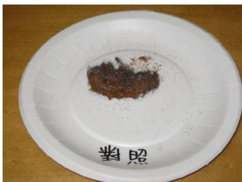
圖12 浸泡過自來水的鋼棉
