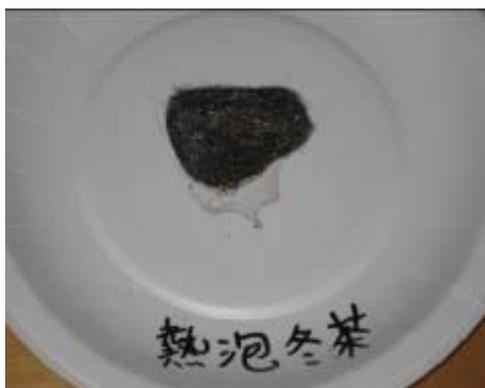
圖10 浸泡過熱泡冬茶的鋼棉
