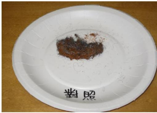
圖15 浸泡過自來水的鋼棉
