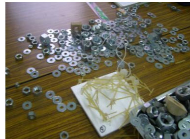
四邊的直立麵條都斷了 直立的麵條先斷裂再壓斷側面
