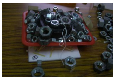
垂直壓在麵條結構上 像世貿大樓倒下的方式
